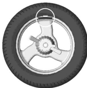
Рисунок 6.6 - Груз установлен в «12 часов»
